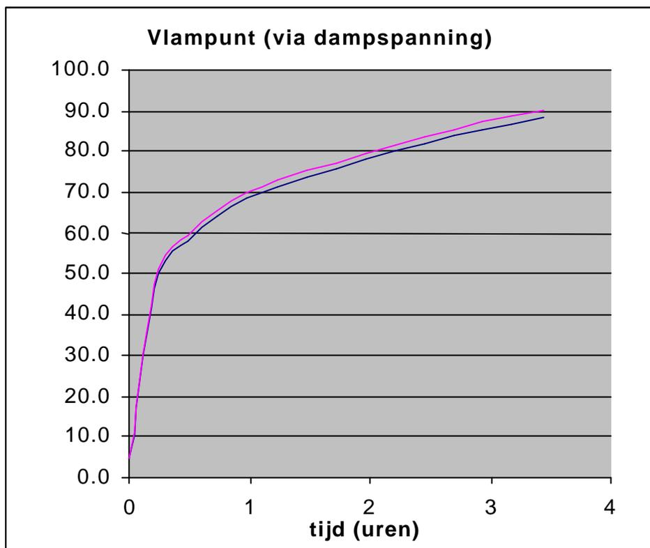
Figuur 2 Vlampunt als gevolg van partiële dampspanning van overige componenten
