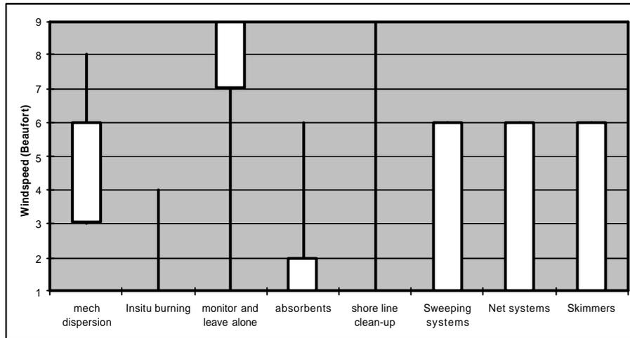
**Figure 5** Feasibility of a few response options as a function of the wind speed (Beaufort) (waar wordt naar deze figuur verwezen??)
